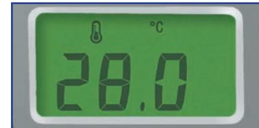
Entspricht die Temperatur des Wasserkerns der Temperatur auf dem Display, dann ist das Symbol °C dauernd an.
